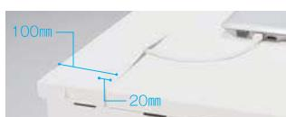
大型の奥行100mmのケースウェイカバー(有効開口寸法56mm)を採用。またケースウェイカバー前部には、コードを通したときにすきまができるにくい軟質樹脂のソフトエッジ(幅20mm)を採用。
